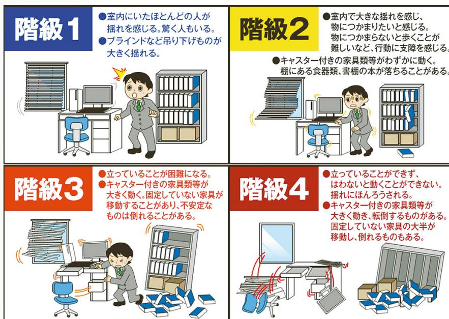
図1 長周期地震動階級と人の体感・行動、室内の状況等の関連（気象庁ウェブページより）
