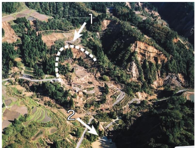
写真1 山古志村の地すべりと河道閉塞(10月24日撮影、中日本航空提供)。棚田上部のため池の水が亀裂によって抜け、その下が大きく崩壊した。
