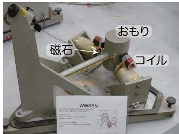
写真2 世界標準地震観測網で採用された水平動成分を観測する地震計 (建築研究所に展示)
